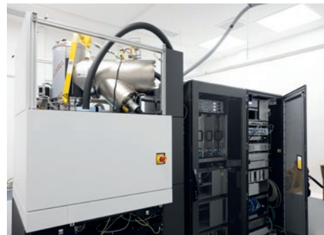
Le cryomicroscope Glacios™ Cryo-TEM de Thermo Fisher
